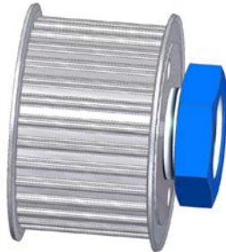
Abb.: 10 Befestigungsmutter um 2 - 3 Umdrehungen gelöst
